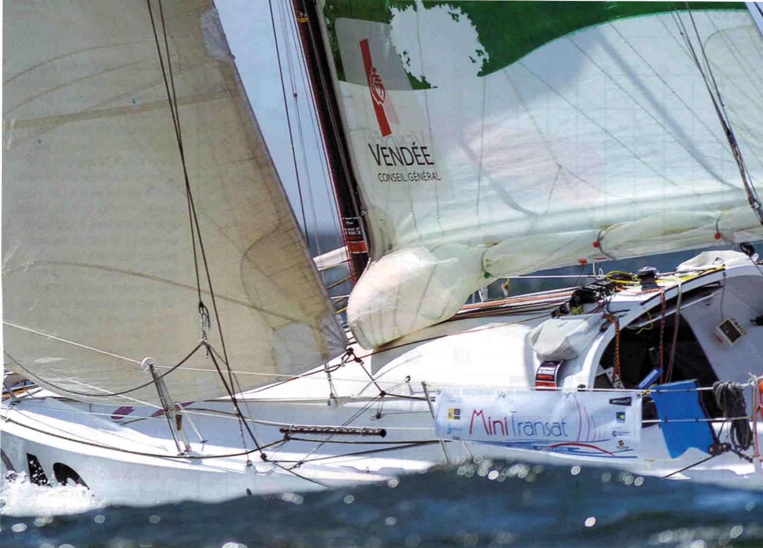
qu'avec un Code 5, plus plat car conçu pour attaquer au large. La 8e voile est un gennaker réalisé en polyester film (laminé). Les grand-voiles sont "full batten". Comptez 6 lattes qui viennent en butée sur la ralingue du mât. Les martyrs en extrémité sont à changer régulièrement. "Il n'y a pas de rotule ni de chariot métallique. Ce n'est rien que du textile", précise Rémi.
