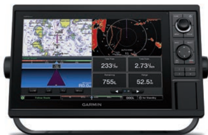
Sur les nouveaux traceurs-lecteurs, on peut consulter des informations sur la gestion du bord, comme ici la consommation. Bien d'autres options sont possibles avec le Wi-Fi intégré.
