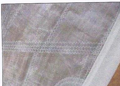
Cuben Fiber : ce détail d'une voile d'avant d'Imoca montre les bandes de Spectra-Kevlar écrasées en filaments et noyées dans la colle. Le Cuben Fiber offre une excellente résistance à la déchirure et un profil très bloqué qui permet une faible déformation dans le temps.
