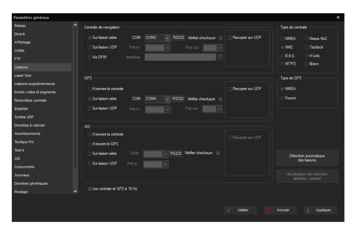
La solution la plus simple est d'utiliser la fonction **Détection automatique des liaisons** (bouton en bas à droite de la fenêtre). Adrena va scruter les différentes liaisons séries et vous proposera la configuration des ports COM qu'il a repéré. Vous n'avez ensuite plus qu'à appliquer cette configuration. N'oubliez pas de **Valider** la fenêtre Paramètres Généraux pour prendre en compte les modifications apportées.
